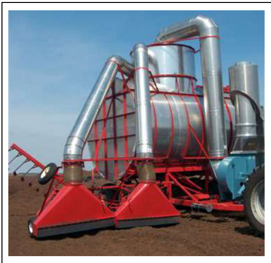
Fig. 2 – Raccolta per aspirazione della torba dopo la fresatura.
