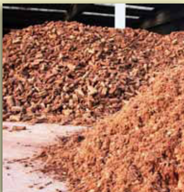
Sullo sfondo mattonelle di torba non lavorata. In primo piano la torba dopo la prima macinatura
